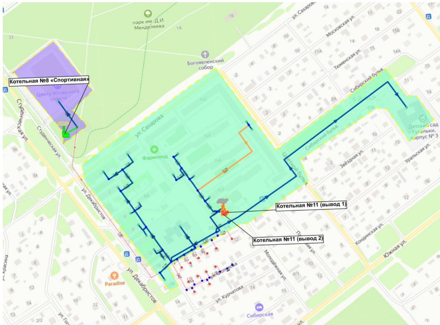
Рисунок 6. Схема трассировок сетей котельной № 11 до переключения потребителя на котельную «Спортивная» № 8
