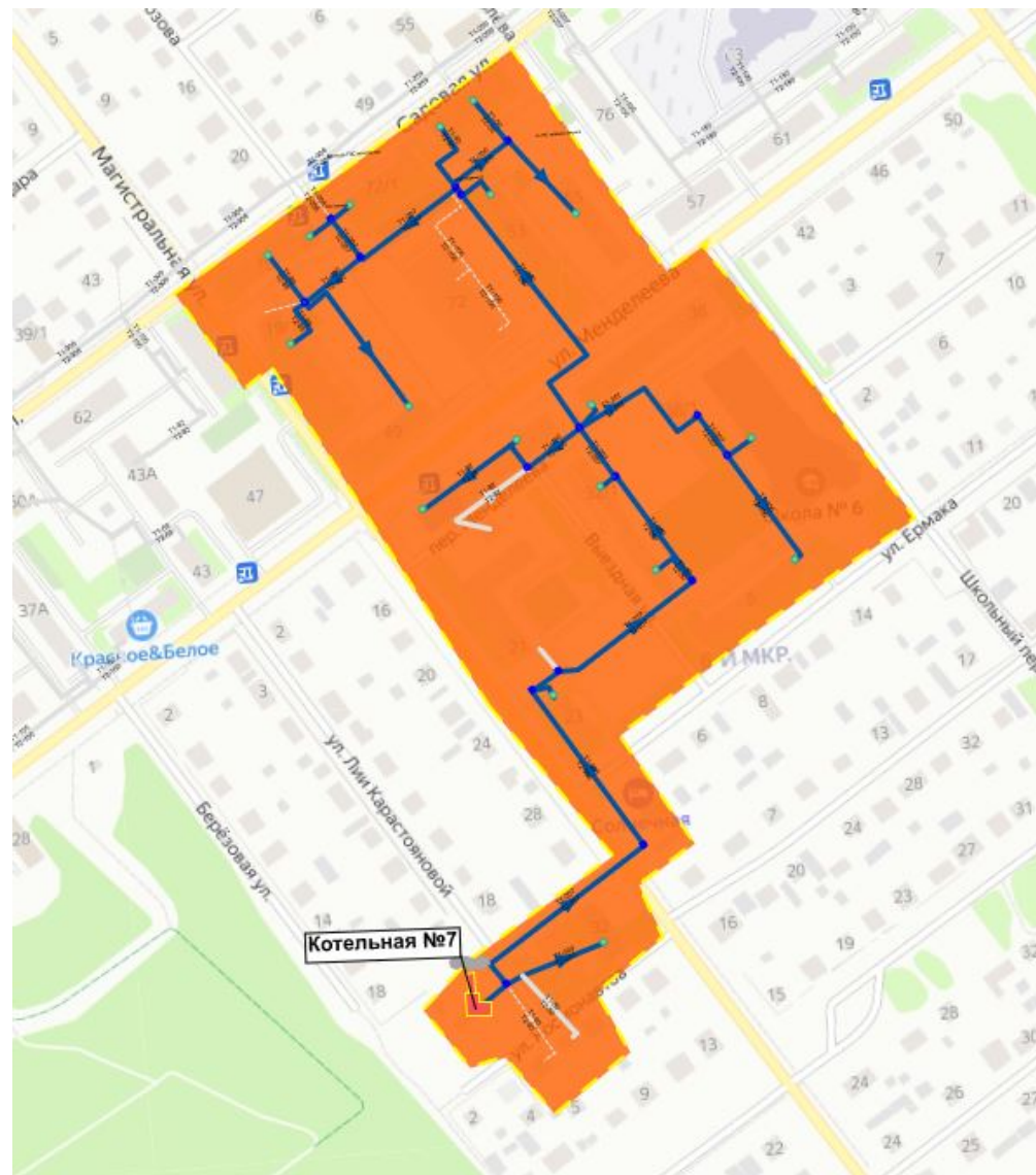
Рисунок 14. Схема трассировок сетей котельной № 7 до переключения на котельную «Финская» № 7
