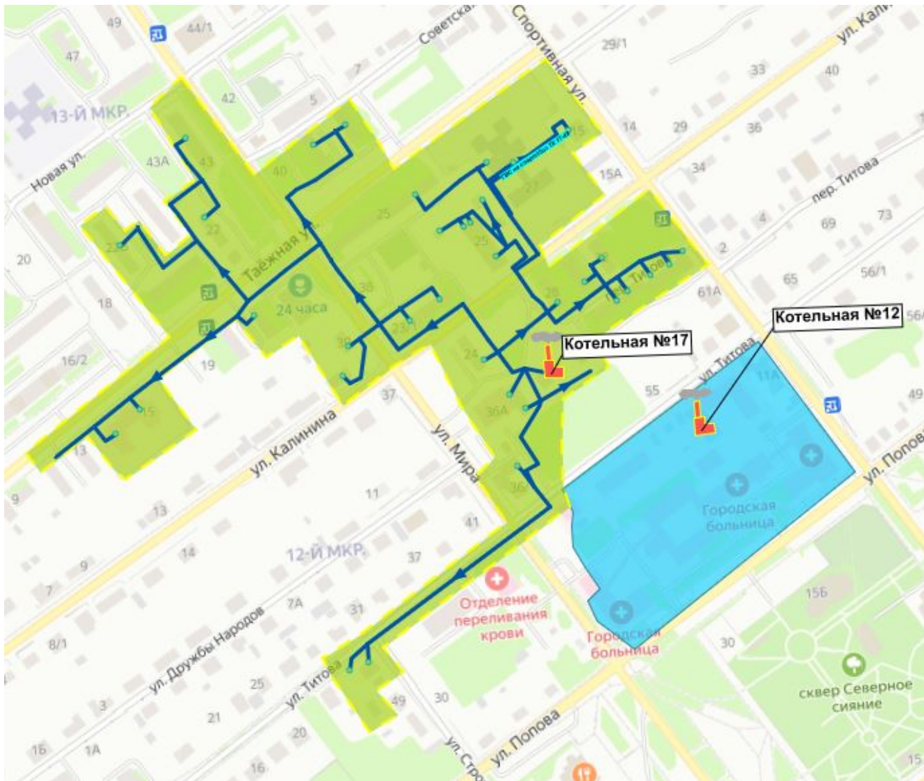
Рисунок 8. Схема трассировок сетей котельных № 17 и № 12 до переключения на котельную «Калининская» № 4
